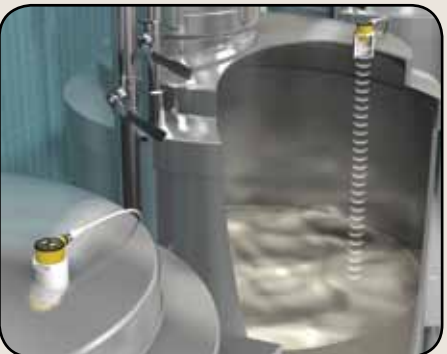
Medição de nível de líquidos em tanques
