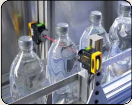
Verificação de nível de líquido em recipiente selado
